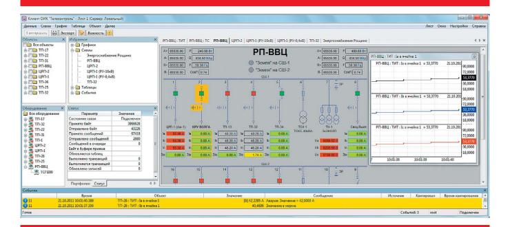
Автоматизированная система управления технологическими процессами распределения электрической энергии (далее система АСУ ТП) выполняет функции автоматизированного дистанционного контроля и управления коммутационными аппаратами, цифровыми защитами и другими интеллектуальными устройствами энергообъекта.
