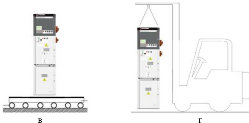
Рис. 16. Способы перемещения шкафов КРУ на транспортном поддоне а – вилочным автопогрузчиком; б – ручной подъемной тележкой; в – на валках; г – подъемными механизмами
