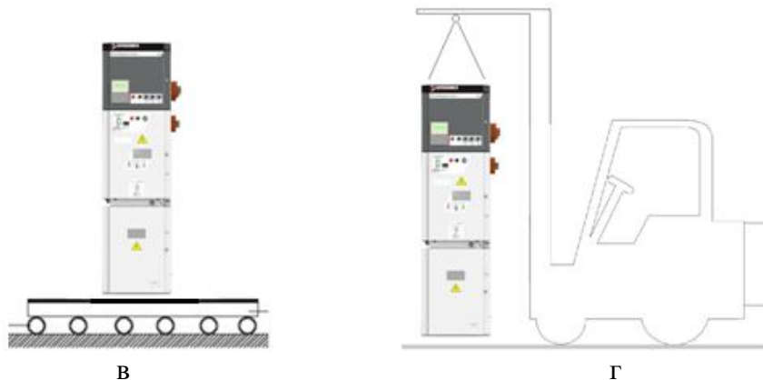
Рис. 16. Способы перемещения шкафов КРУ на транспортном поддоне
