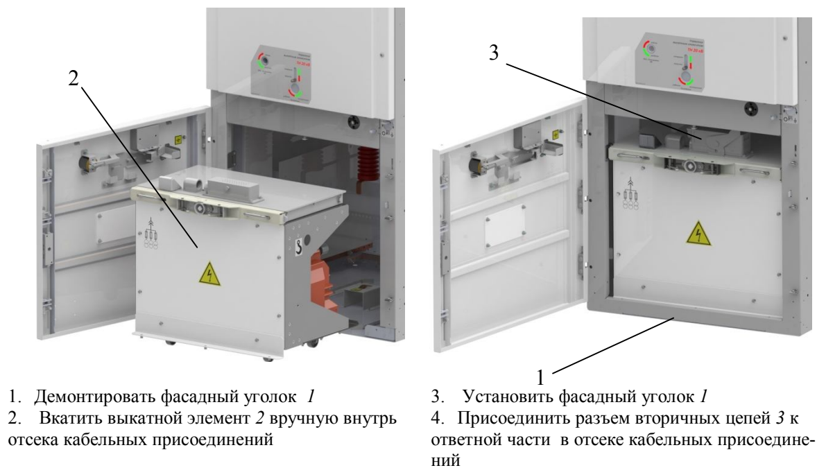
Рис. 32 Порядок монтажа выкатного элемента с измерительными трансформаторами напряжения в отсек кабельных присоединений
