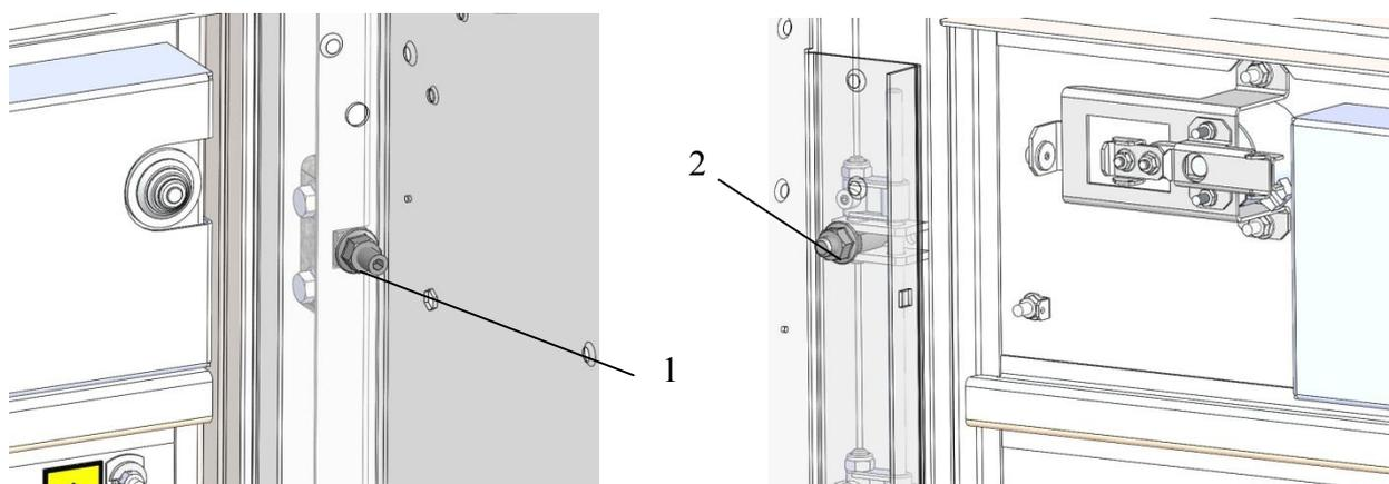
**Рис. 29** Крепление петель дверей и проушин замка (вид изнутри)
