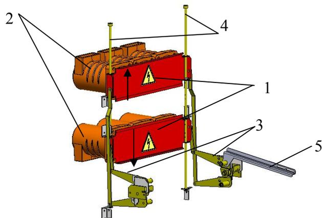
**Рис. 10 Шторочный механизм**
