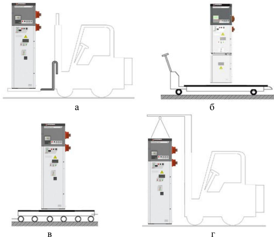
**Рис. 16 Способы перемещения шкафов КРУ на транспортном поддоне**
