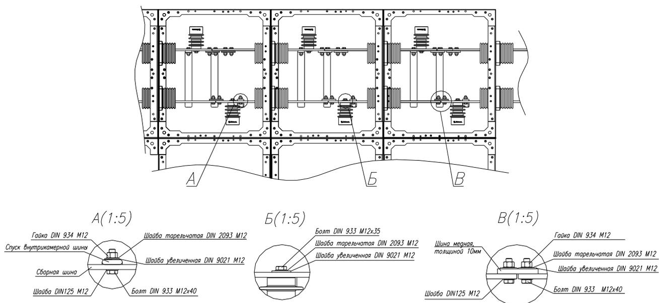
**Рис. 24 Монтаж сборных шин 1600 А (вид сверху на шкафы КРУ)**
