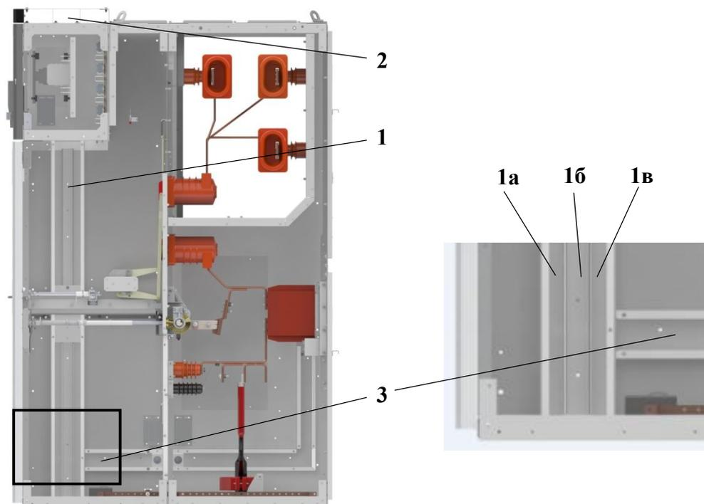
**Рис. 15 Кабельные каналы для прокладки жгутов проводников вторичных цепей**
