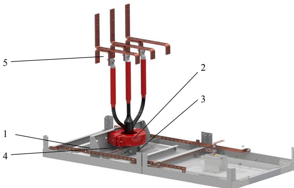
**Рис. 27 Монтаж кабеля в отсеке кабельных присоединений**
