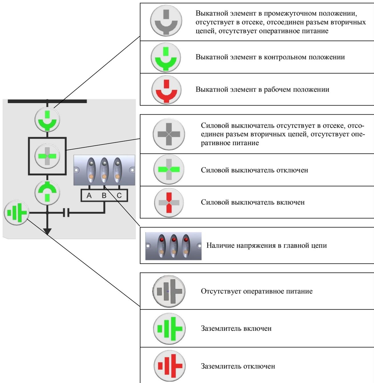
**Рис. 4 Индикация на двери отсека выкатного элемента**
