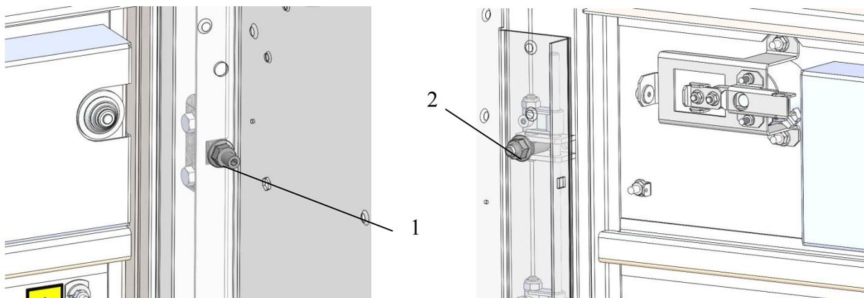
**Рис. 33 Крепление петель дверей и проушин замка (вид изнутри)**
