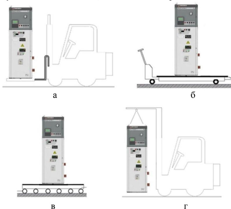
**Рис. 16 Способы перемещения шкафов КРУ на транспортном поддоне**
