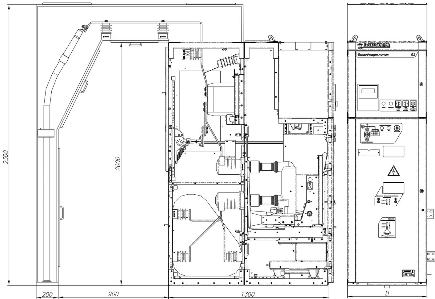
Рис. 2.3 Габаритные размеры шкафов КРУ.
