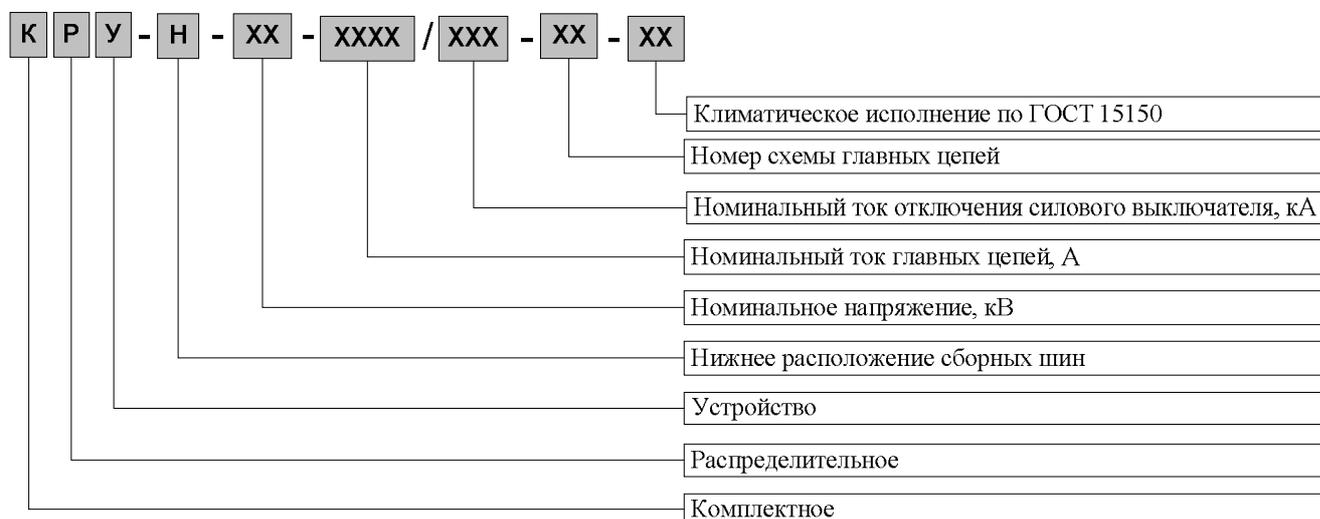
Пример записи условного обозначения: КРУ-Н-10-2500/31,5-1-У3 – комплектное распределительное устройство с нижним расположением сборных шин, на номинальное напряжение 10 кВ, номинальный ток 2500 А, на номинальный ток отключения 31,5 кА, со схемой главных электрических цепей № 1 климатического исполнения и категории размещения У3.
