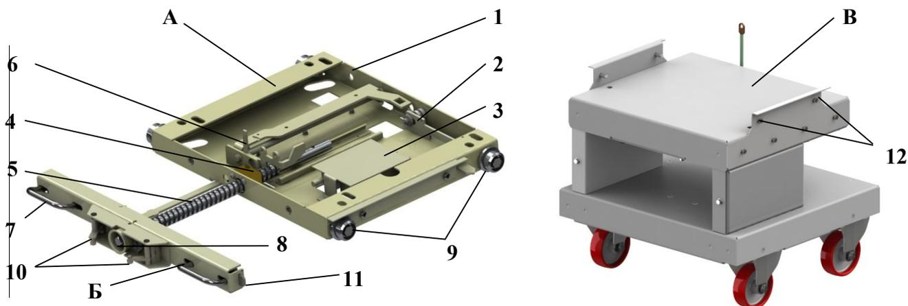
**Рис. 8 Тележка аппаратная:**
