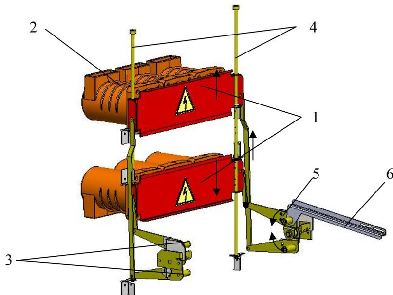
**Рис. 10 Шторочный механизм**
