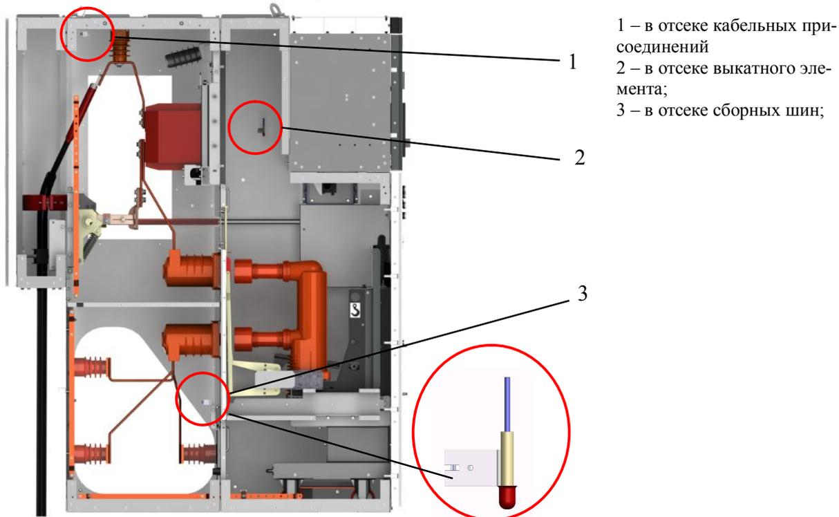
1 – в отсеке кабельных присоединений
