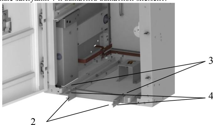
Рис. 19 Порядок демонтажа выкатного элемента
