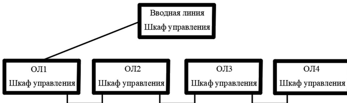
Рис. 13 Система передачи данных между шкафами управления.
