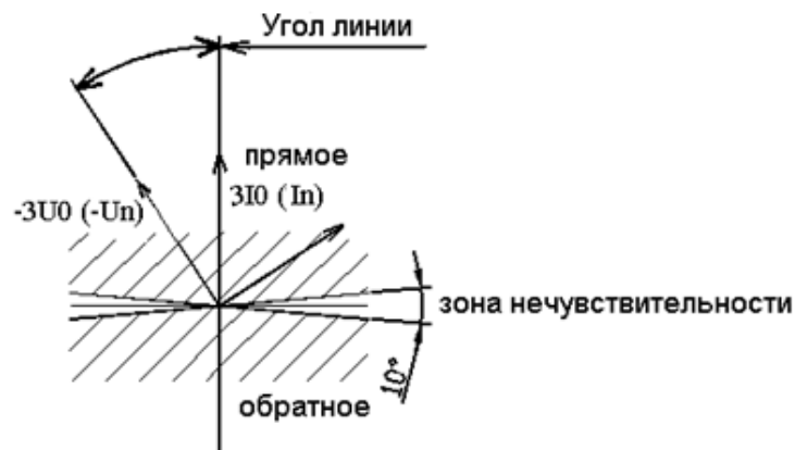
Рисунок 6.13 – Зона срабатывания направленной токовой защиты I^* (режим 3I_0 для всех видов защит)
