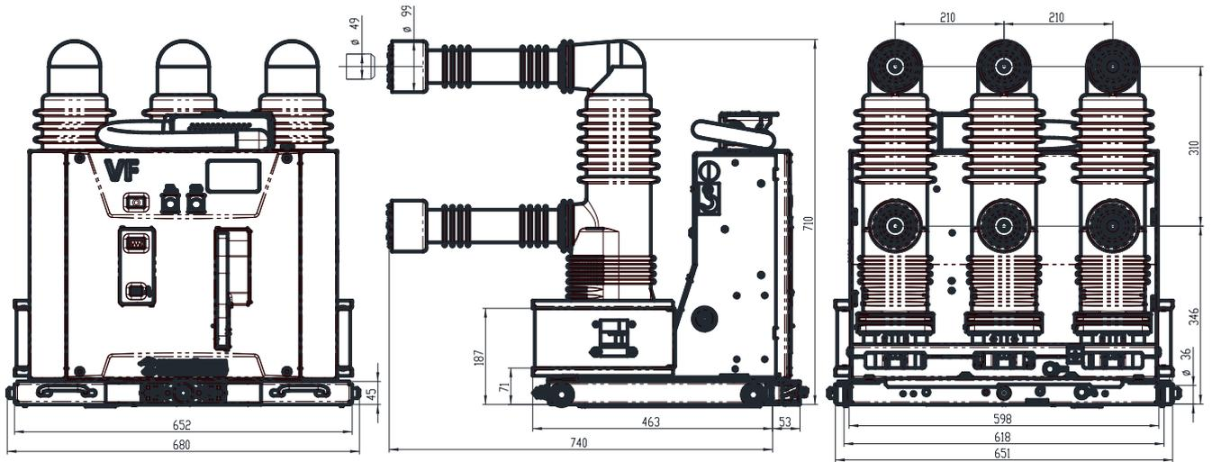
Рис. 1.5 Габаритно-присоединительные размеры выключателей в исполнении М
