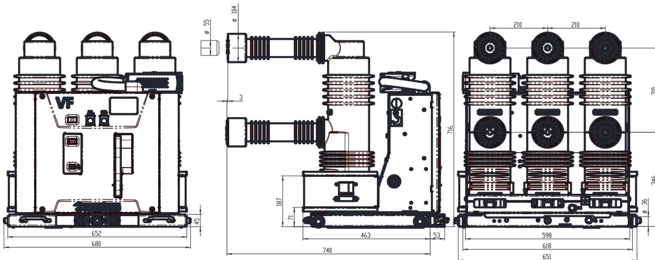
Рис. 1.7 Габаритно-присоединительные размеры выключателей в исполнении М
