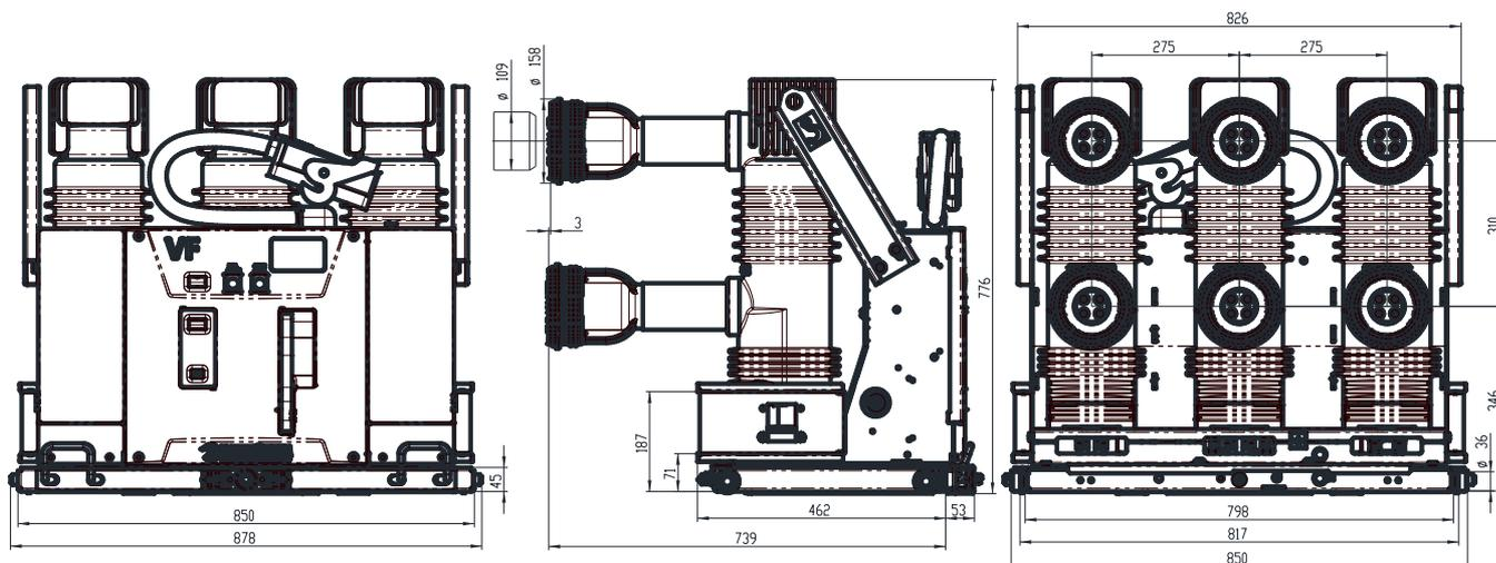
Рис. 1.8 Габаритно-присоединительные размеры выключателей в исполнении М
