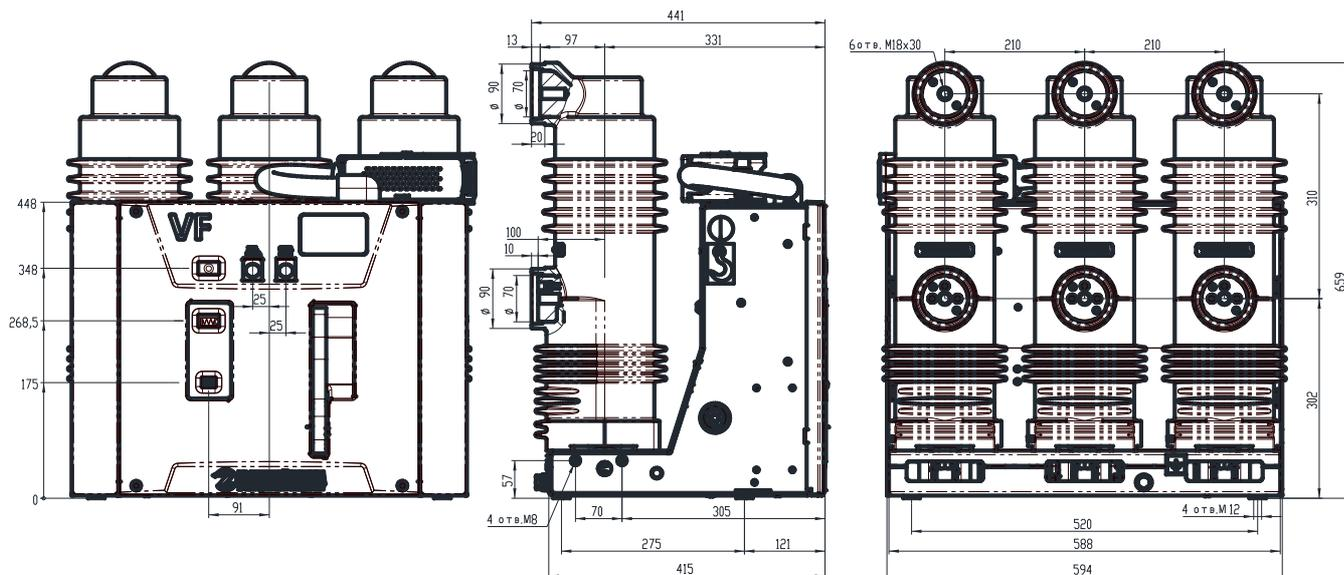
Рис. 1.3 Габаритно-присоединительные размеры выключателей в исполнении S
