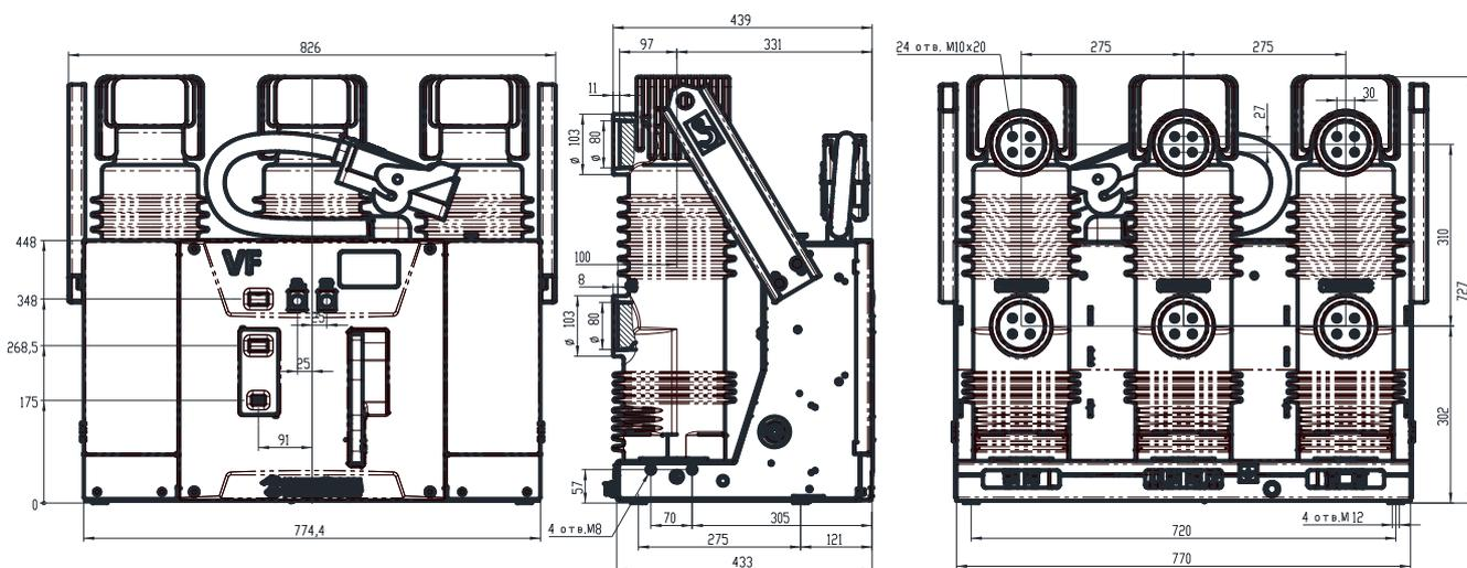
Рис. 1.4 Габаритно-присоединительные размеры выключателей в исполнении S
