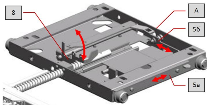
**Рис. 6 Механические блокировки:**
