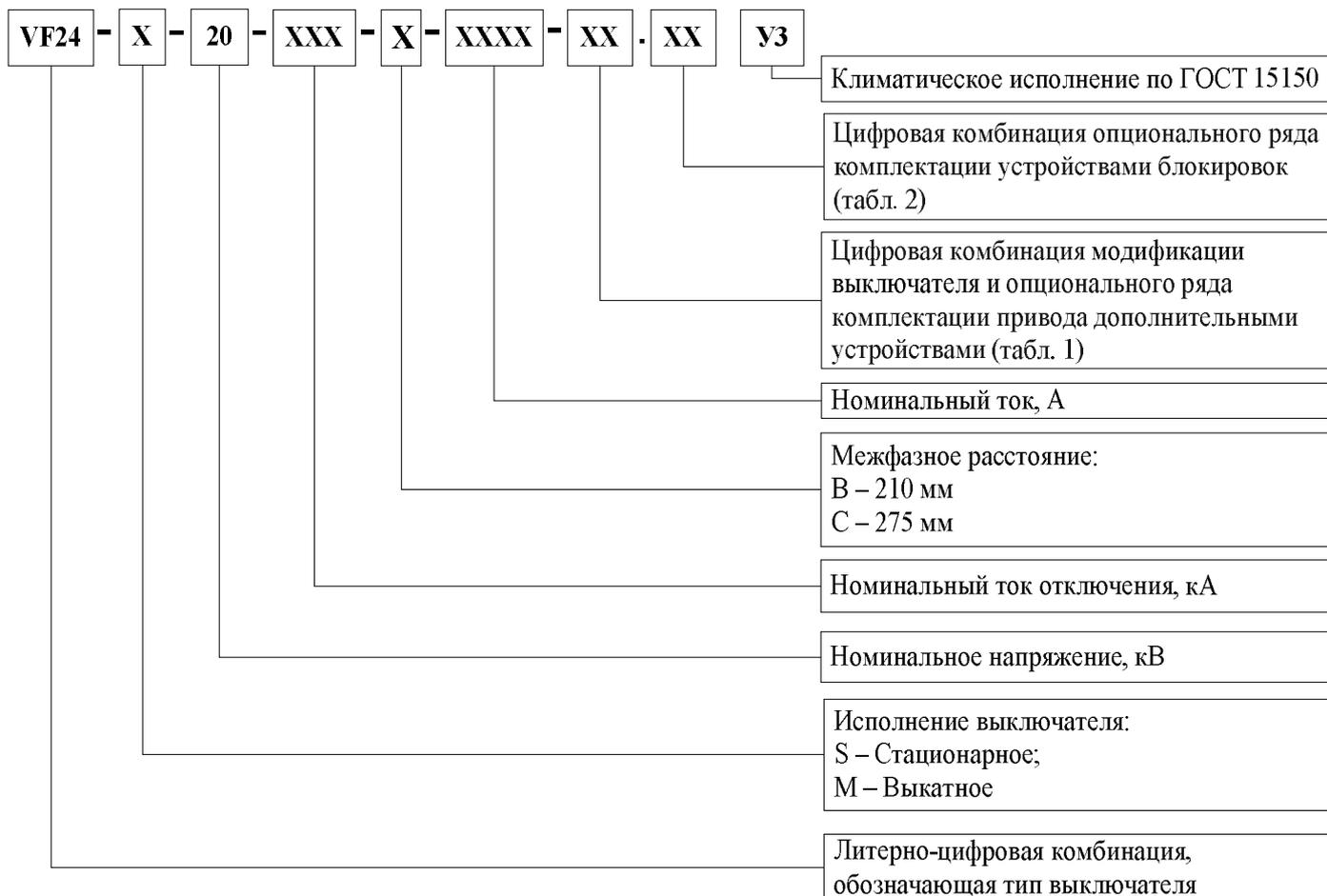
Пример записи условного обозначения выключателя: VF24-M-20-20-B-1250-02.04 УЗ – выключатель вакуумный в выкатном исполнении на номинальное напряжение 20 кВ, номинальный ток отключения 20 кА, с межфазным расстоянием 210мм, номинальный ток 1250 А, напряжение цепей управления 220 В с максимальными расцепителями тока 5А, электромагнитной блокировкой включения при отсутствии оперативного питания, климатическое исполнение УЗ.
