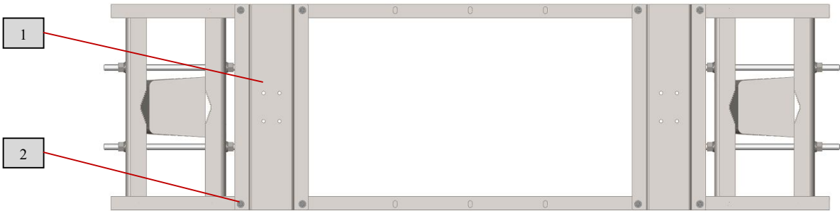
Рис.48 Монтаж кронштейнов для ТСН
