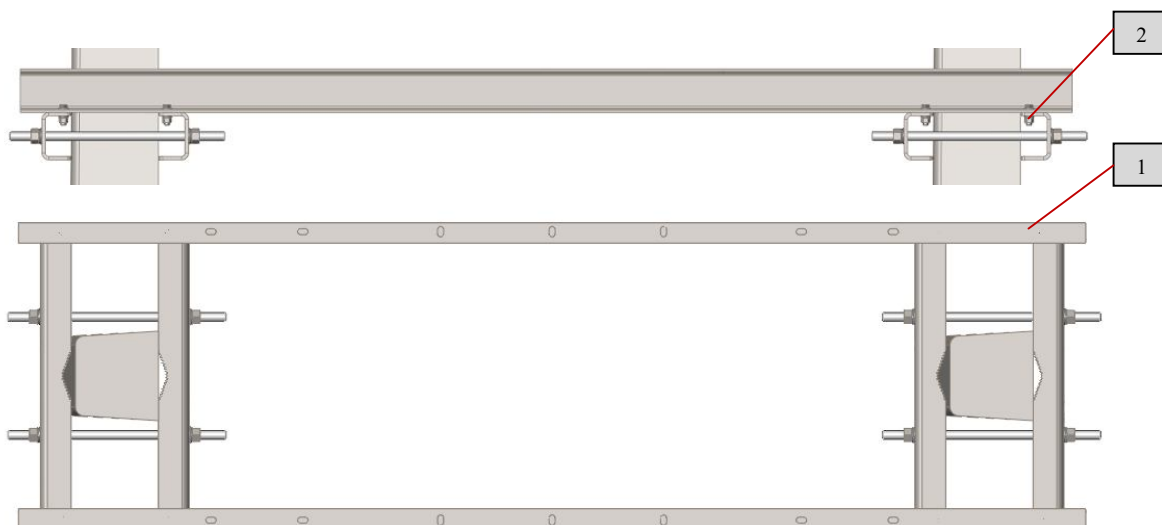
Рис.47 Установка несущих швеллеров
